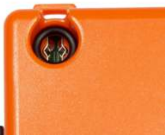
Assurez-o-ring est correctement installé
