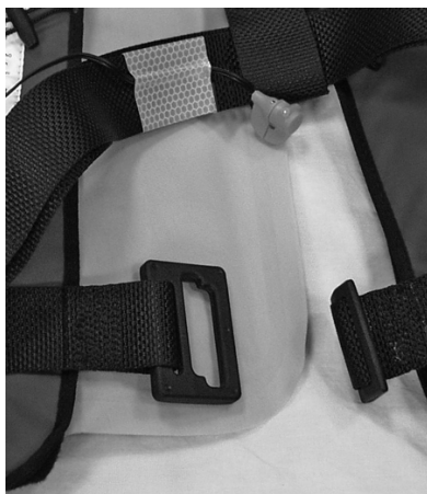
Exemple de capteur scotchée à dos courroie de gilet de sauvetage pour assurer leur immersion
